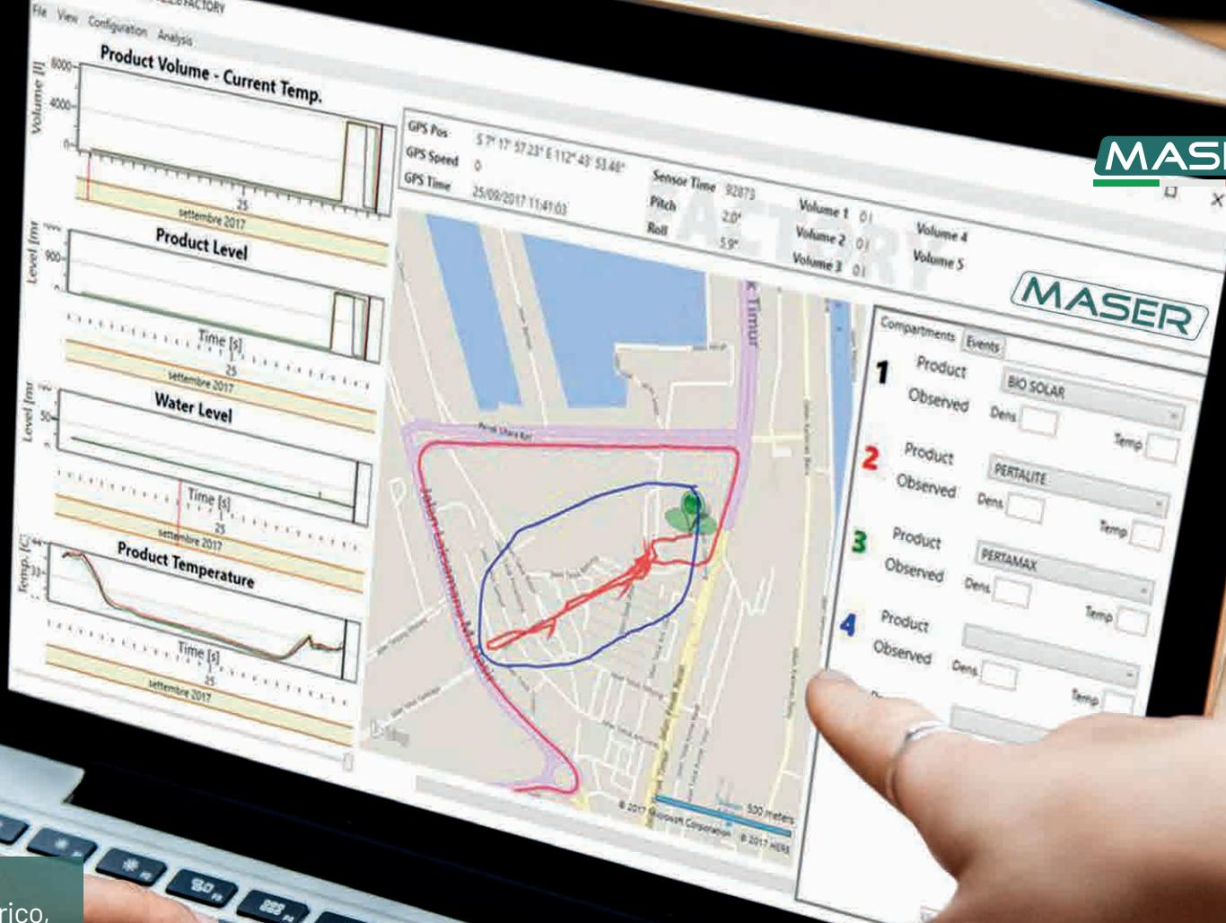
Dal deposito al punto di scarico, l'operatore a remoto di un tts può controllare parametri e caratteristiche del prodotto trasportato. I "data log" sono conservati e sicuri per il monitoraggio di tutti gli eventi che accadono sulle guarnizioni elettroniche presenti sulle valvole di entrata e di uscita del camion cisterna.
